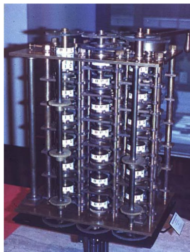
Figura 1.10: Pequena seção da máquina diferencial de Charles Babbage .
