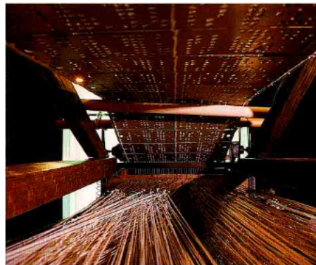
Figura 1.8: Máquina de tear usando programação através de cartões perfurados.
