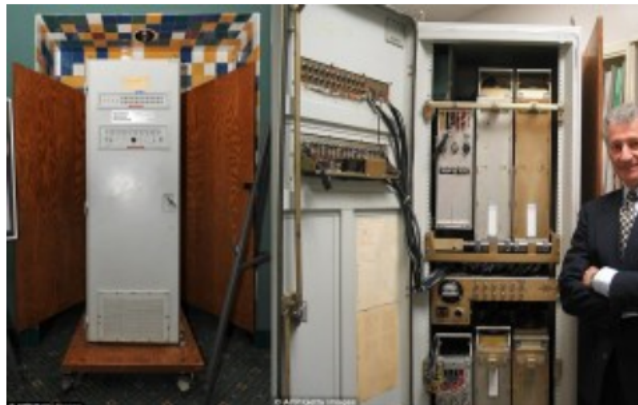
Figura 7.12: Leonard Kleinrock diante do primeiro Interface Message Processor (IMP), precursor dos roteadores de mensagens atuais.
