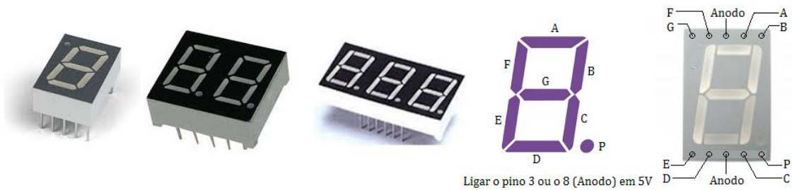
Figura 11 – Exemplos de mostradores (em inglês displays) de 7 segmentos e sua nomenclatura.
