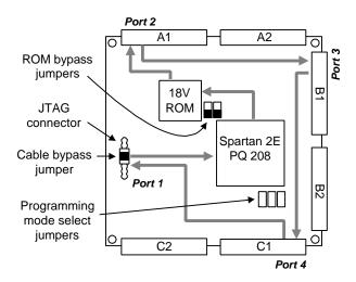
Figure 2. JTAG Signal Routing on D2-SB
