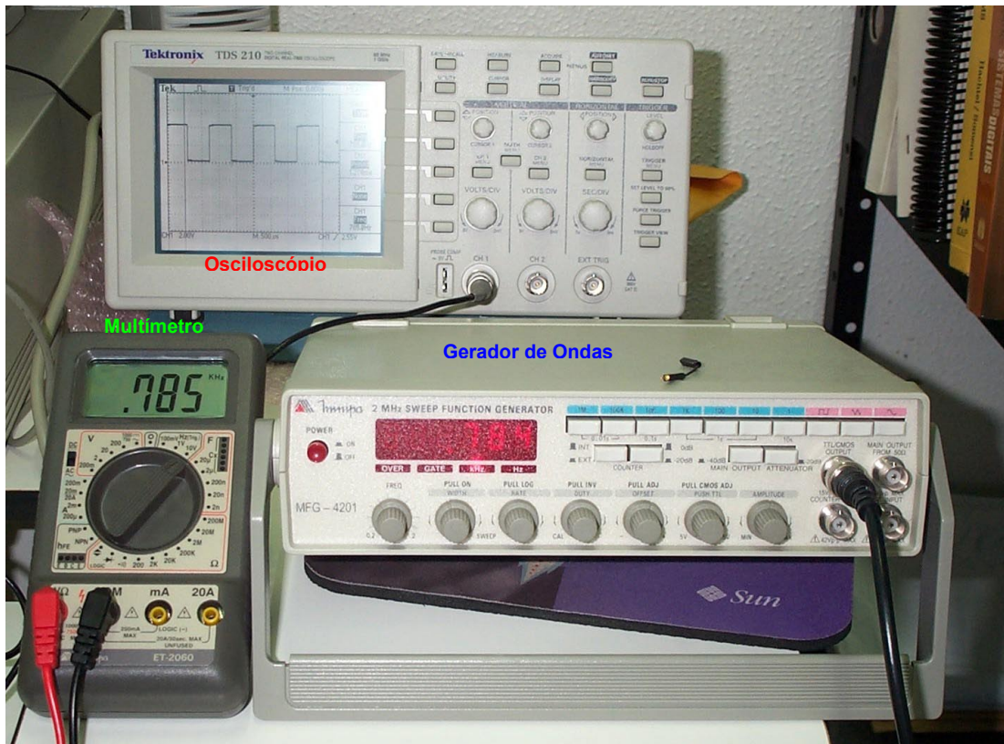
Figura 2 – Equipamentos de excitação e medida de sinais elétricos: multímetro, gerador de ondas e osciloscópio.
