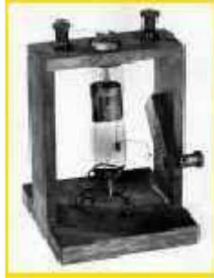
1906 - Lee de Forest soma uma terceira válvula para controlar o atual fluxo para o diodo de Fleming e cria o tubo de diodo à vácuo de três elétrodos.
