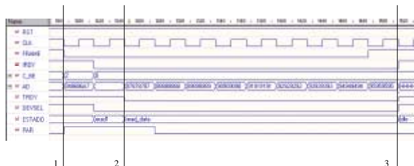
Figura 8 - Sinais do ciclo de acesso de leitura no modo burst . O sinal FRAME# permanece ativo (nível lógico 0) durante toda a fase de leitura.
