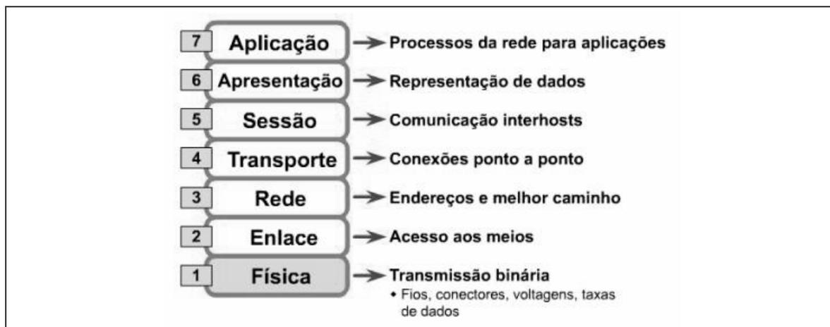
Figura 9 - Camadas do modelo OSI.
