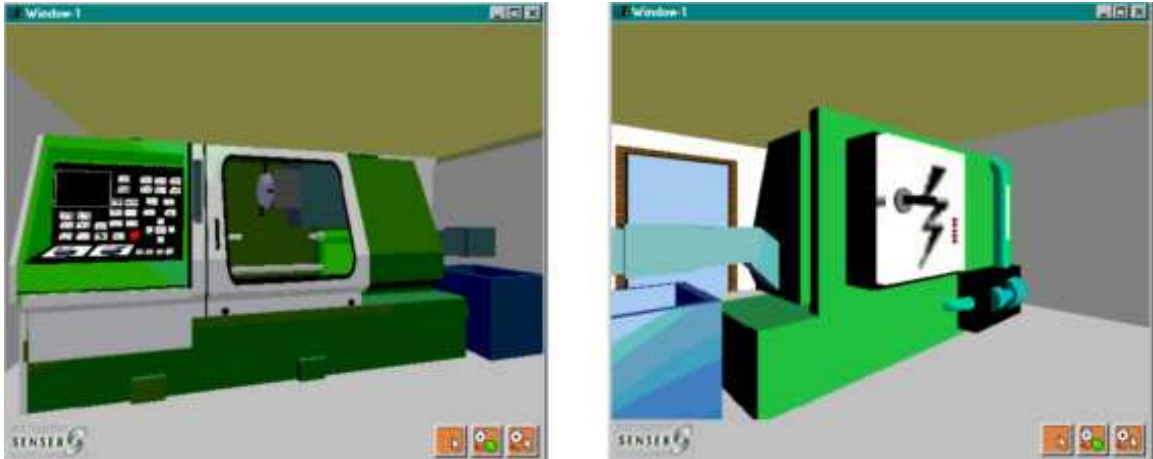
Figura 3.5 - Vista frontal e traseira do torno CNC com os botões do gerador de falha
