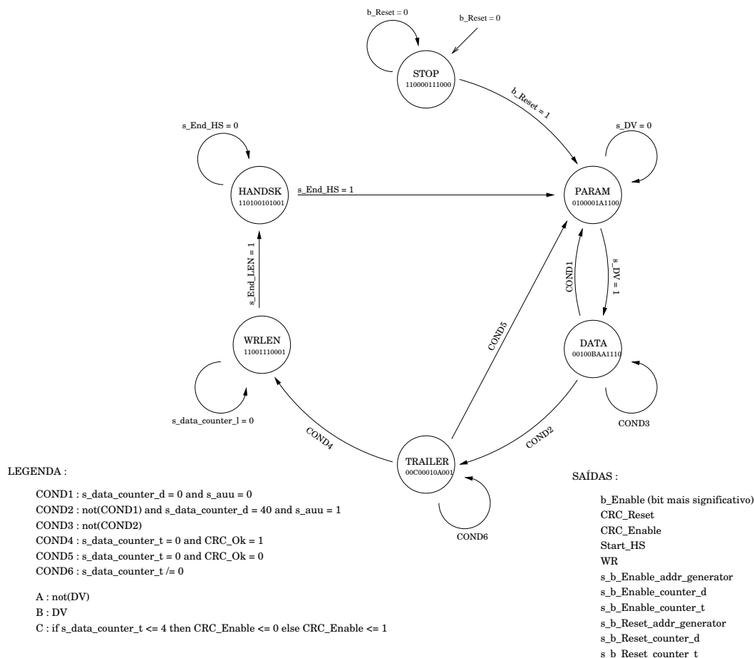
Figura 5.8: Máquina de estados para o processo de recepção de dados pela AAL 5 - Receive State Machine .
