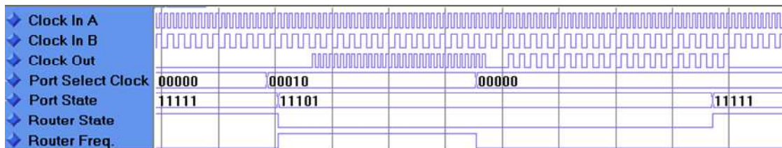
Figura 58 – Simulação do controlador de relógio.
