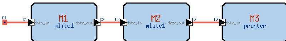
Figura 38 – Cenário de validação da comunicação entre dois processadores MLite.
