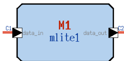
Figura 17 – Módulo do processador MLite criado no ambiente System Studio: representação do processador e de sua interface. O retângulo chanfrado representa a instância do módulo e os quadrados com seta os dois canais FIFO para comunicação de entrada e saída.
