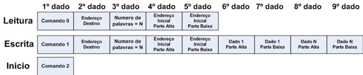
Figura 19 – Formatos de pacotes recebidos do Hospedeiro pelo IP Serial. Todos os dados são de 8 bits.
