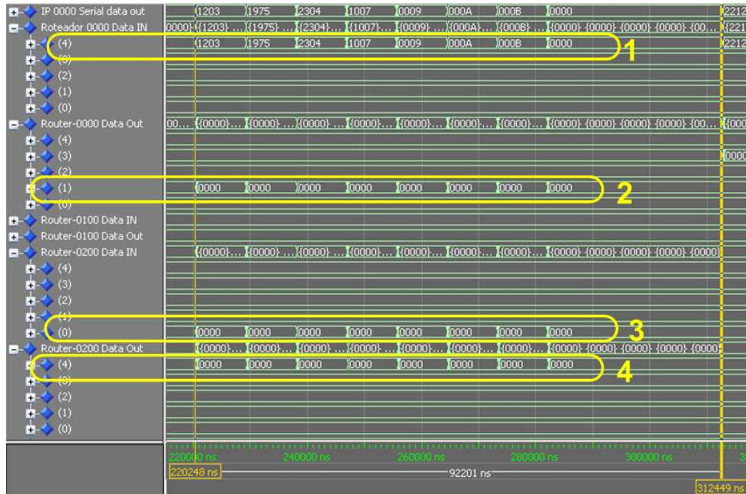
Figura 34 - Forma de onda mostrando uma simulação sem atraso de um processo de transmissão de pacotes do IP 00 ao IP 20. Os sinais mostrados para os pontos 2-4 não mostram o valor esperado como ocorre em 1, mas isto é devido a falhas de detalhamento da visualização e não a erros de simulação.
