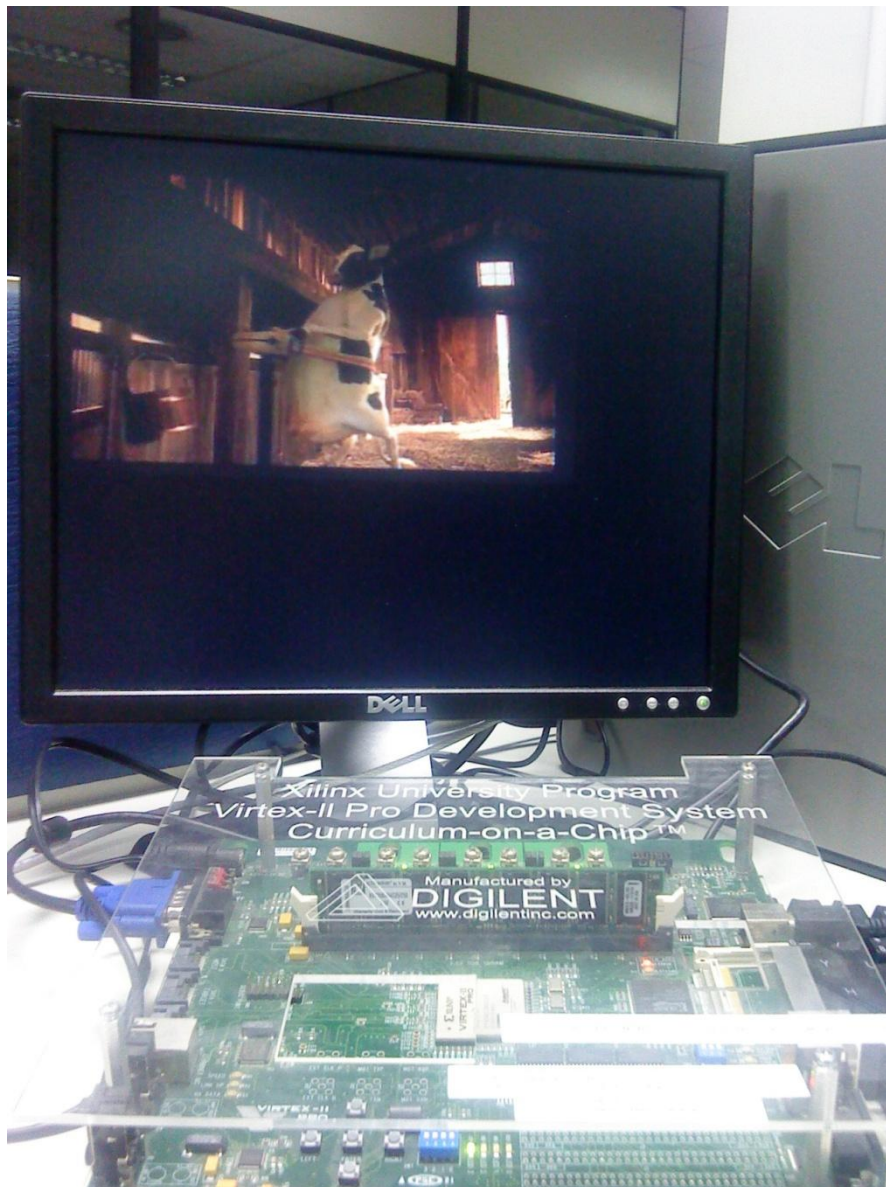
Figura 5.1 - Prototipação inicial de um vídeo em M-JPEG.
