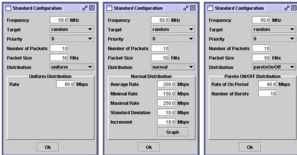
Figura 2.18 - Configuração padrão para tráfego (a)uniforme; (b)normal; (c)pareto.
