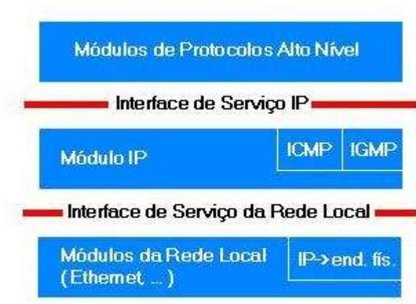
Figura 19 - Níveis estruturais passíveis de modificação no suporte a multicast do protocolo IGMP [DEE89].
