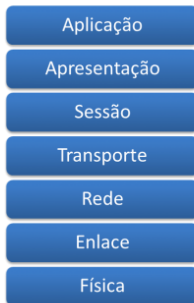
Figura 1: Disposição das camadas do modelo OSI da ISO.
