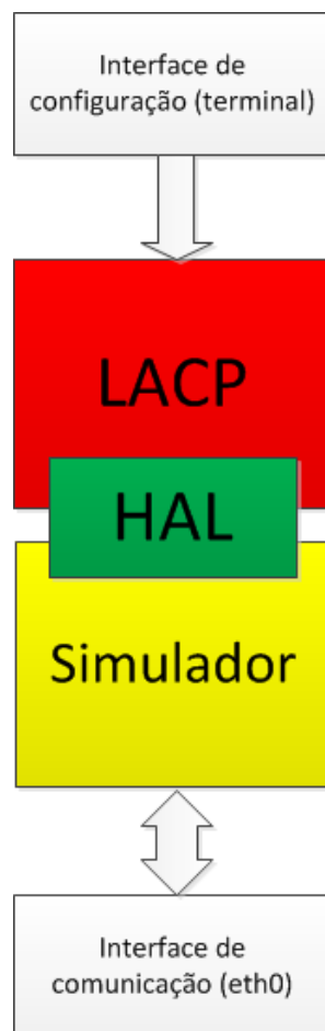
Figura 21: Arquitetura geral do sistema de simulação para o LACP.
