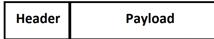
Figura 32: Definição de um pacote, formado pelos campos de Header e Payload, onde um representa informação de controle de transmissão e o outro contém os dados do pacote.
