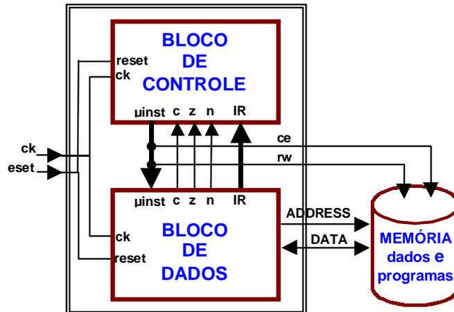
Figura 1 – Diagrama de blocos do processador Cleópatra e comunicação com a memória externa.
