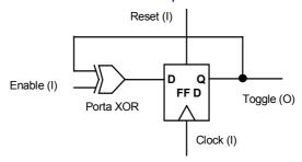
35. A partir do diagrama de esquemáticos abaixo, gere uma descrição VHDL com a mesma funcionalidade, sob a forma de um par entidade-arquitetura. Não se esqueça de definir as entradas e saídas corretamente. Para facilitar, a saída está marcada com (O) e entradas com (I). Todos os fios são simples, e não barramentos. Caso necessite, defina sinais internos e anote-os no esquemático.
