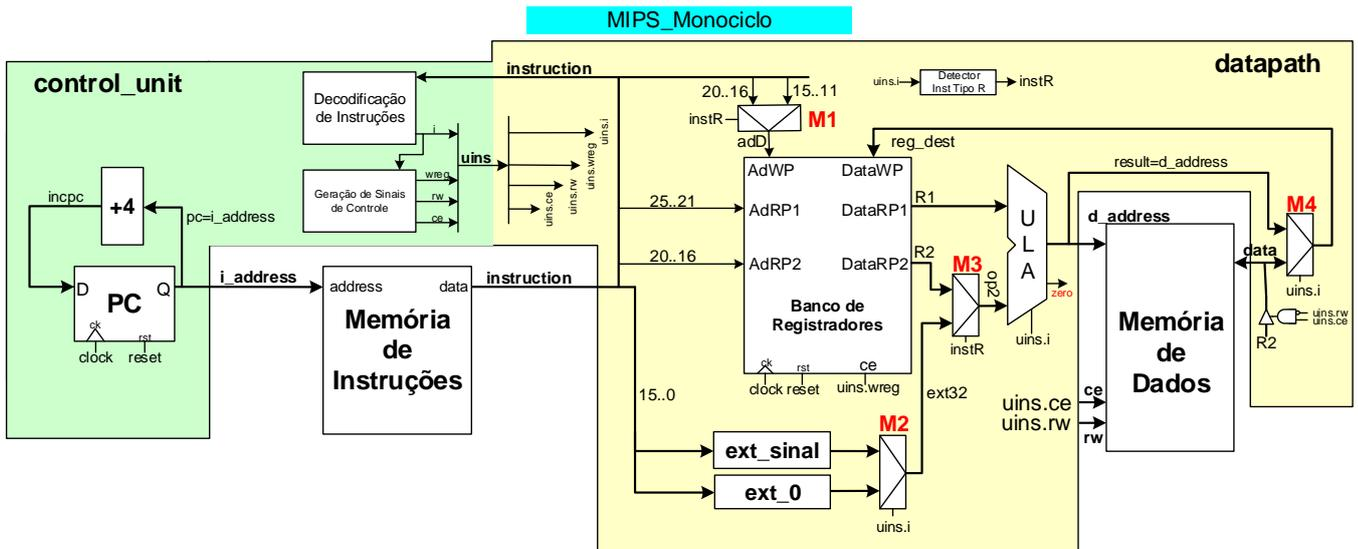
1. [3,0 pontos] Na organização MIPS monociclo mostrada acima, existe no bloco de dados (**datapath**) um módulo de hardware que implementa o sinal **instR**, um detector de quando uma instrução sendo executada é do tipo R. O código VHDL que corresponde à descrição deste módulo é dado abaixo.
