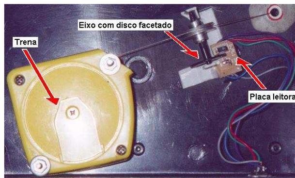
Figura 7 – Visão interna de um Leitor[1]
